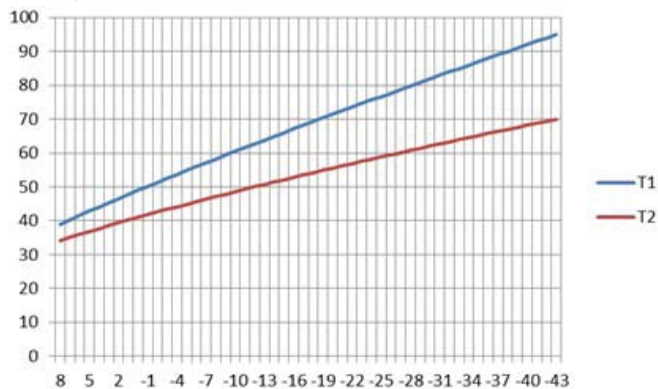
Рисунок 17 - Температурный график тепловой сети
