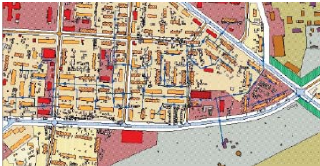
Рисунок 10 - Схема централизованного теплоснабжения от котельной № 4 п. Игрим
