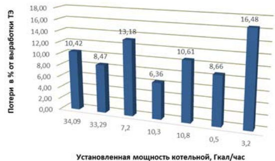
Рисунок 22 - Доля потерь тепловой энергии в зависимости от мощности источника Фактические нормативы технологических потерь по источникам
